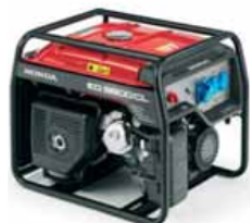
EG3600 Félprofi áramfejlesztő 3.6kVA max. teljesítmény 3.2 kVA foly. teljesítmény 13.9 A folyamatos áram D-AVR szabályzás Olajszint érzékelő Hőkioldó Ellenálló védőkeret Rezgés- és zajcsillapítás
