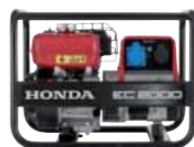
EC2200 Ipari áramfejlesztő 2,5 kVA max. teljesítmény 2,1 kVA foly. teljesítmény 9,1 A folyamatos áram Kondenzátoros szabályozás Olajszint érzékelő Hőkioldó Ellenálló védőkeret Rezgés- és zajcsillapítás
