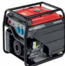
EG5500 Félprofi áramfejlesztő 5.5 kVA max. teljesítmény 5 kVA foly. teljesítmény 21.7 A folyamatos áram D-AVR szabályzás Olajszint érzékelő Hőkioldó Ellenálló védőkeret Rezgés- és zajcsillapítás
