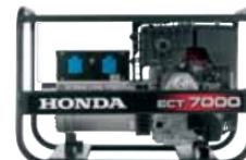
ECT7000 Háromfázisú ipari áramfejlesztő 1f 4 / 3f 7 kVA max. teljesítmény 1f 3,6 / 3f 6,5 kVA foly. teljesítmény 19,5 A folyamatos áram Transzformátoros szabályozás Olajszint érzékelő Hőkioldó Ellenálló védőkeret Rezgés- és zajcsillapítás 1f: 1 fázis, 3f: 3 fázis
