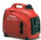
EU10i Hordozható áramfejlesztő 1 kVA max. teljesítmény 0,9 kVA foly. teljesítmény Inverteres szabályozás Echo Throttle (automata gázadagolás) Kompakt méret Zajcsökkentő panelek Olajszint érzékelő Párhuzamos összekötési lehetőség
