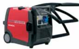
EU30i Handy Hordozható áramfejlesztő 3 kVA max. teljesítmény 2,6 kVA foly. teljesítmény Inverteres szabályozás Echo Throttle (automata gázadagolás) Egyedülálló váz szerkezet Kategóriája legkönnyebb modellje Felhasználóbarát funkciók Olajszint érzékelő
